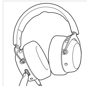
Sidetone (effet local) ne fonctionne pas avec le câble audio ou si le microphone a été débranché.
