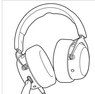
La fonction Mise en sourdine n'est disponible que lorsqu'un appareil connecté accède au microphone.
