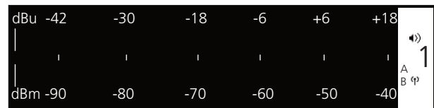
Kombinierte Audio- und HF-Pegelanzeige – Sender ausgeschaltet
