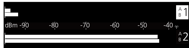
HF-Pegelanzeige – Störung auf Kanal 1
