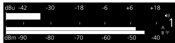
Kombinierte Audio- und HF-Pegelanzeige – Sender eingeschaltet
